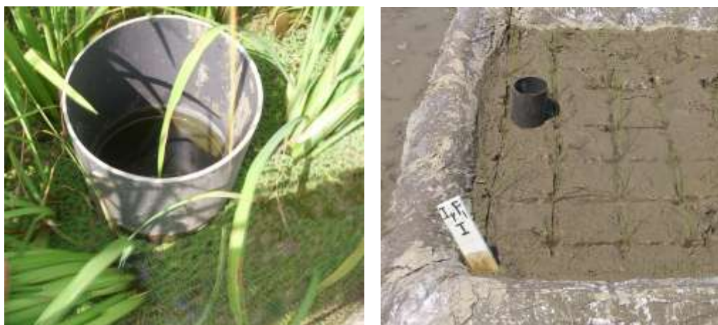
شکل ۱- لوله‌های مشبک کار گذاشته شده در کرت‌ها جهت اعمال تیمار کم‌آبیاری
