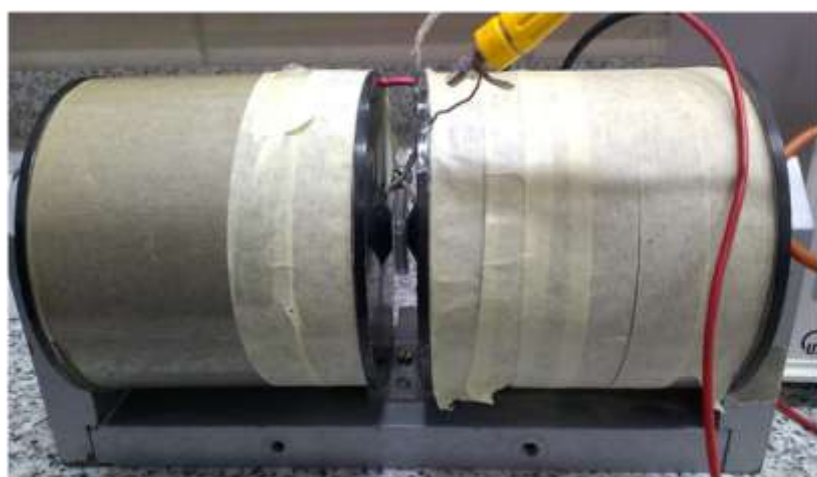
شکل ۱- سیم پیچ هلم هولتز ساخت آلمان
